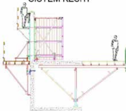
GATS TİP AĞIR SERİ TÜNEL KALIP SİSTEM KESİTİ
